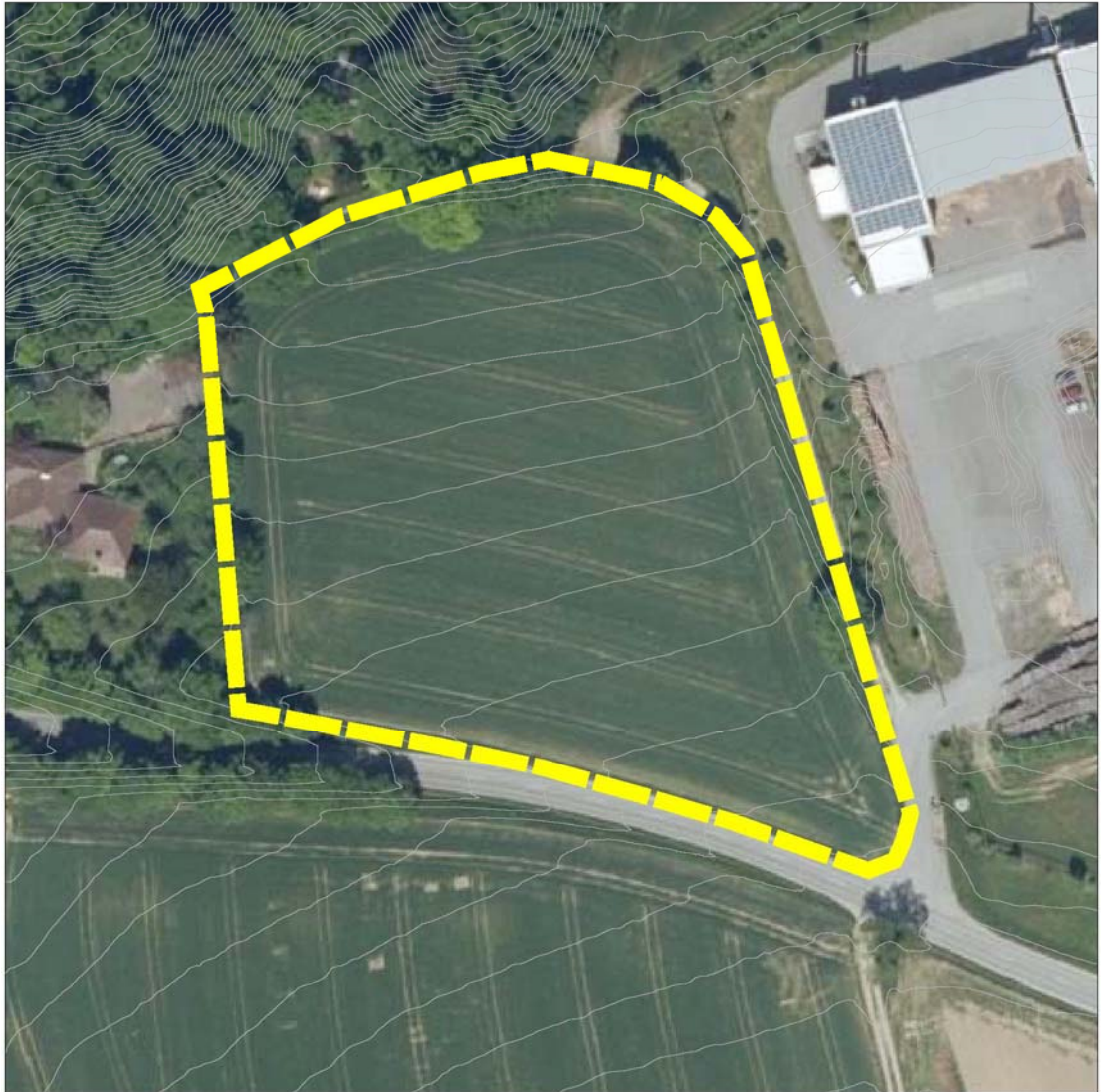
Luftbild der Bayerischen Vermessungsverwaltung mit Darstellung Höhenlinien, Abstand 1,0 m, Geltungsbereich gelb gestrichelt
